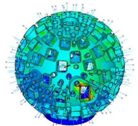
Dimensionnement de la chambre d'expérience du Laser MegaJoules (CEA)
